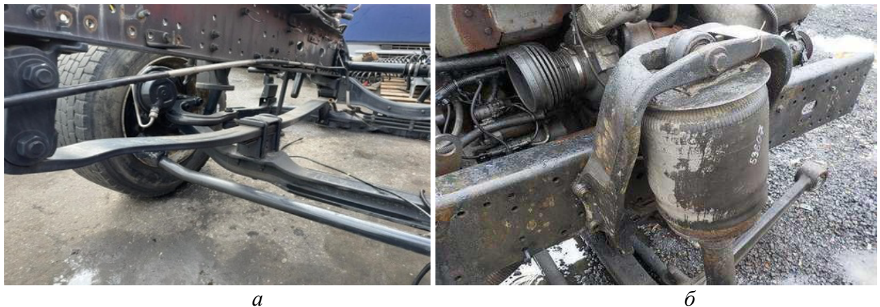
Рисунок 2 – Заміна ресорної підвіски на пневмопідвіску: а - частковий демонтаж старої ресорної підвіски; б - встановлення пневмоподушок
