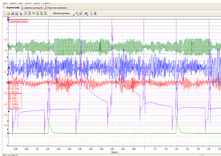
Рисунок 6 - Приклади осцилограми прослуховування ДВЗ виготовленим стетоскопом
