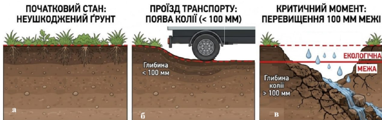
Рисунок 1 – Стадії деградації ґрунтової опорної поверхні: а – поверхня пряма і неушкоджена; б – початкова глибина колії менша за екологічну межу; в – перевищення екологічної межі є критичним порогом, за яким посилюється інтенсивна водна ерозія
