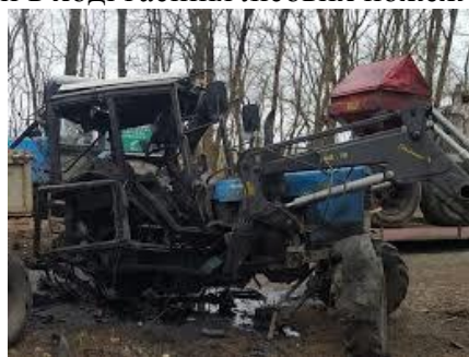
Рис.3. Фото автотракторної техніки пошкодженої внаслідок наїзду на протитанкову міну в Чернігівській області.
