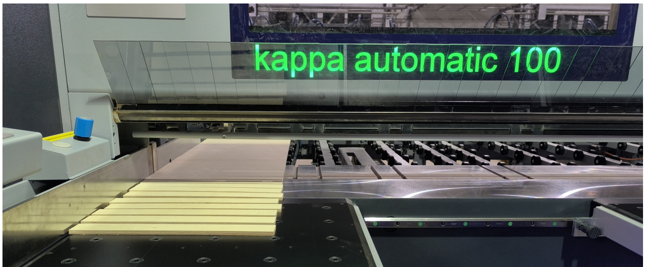
Рис. 2. Розкрій заготовки фанери загального призначення під час експериментальних досліджень
