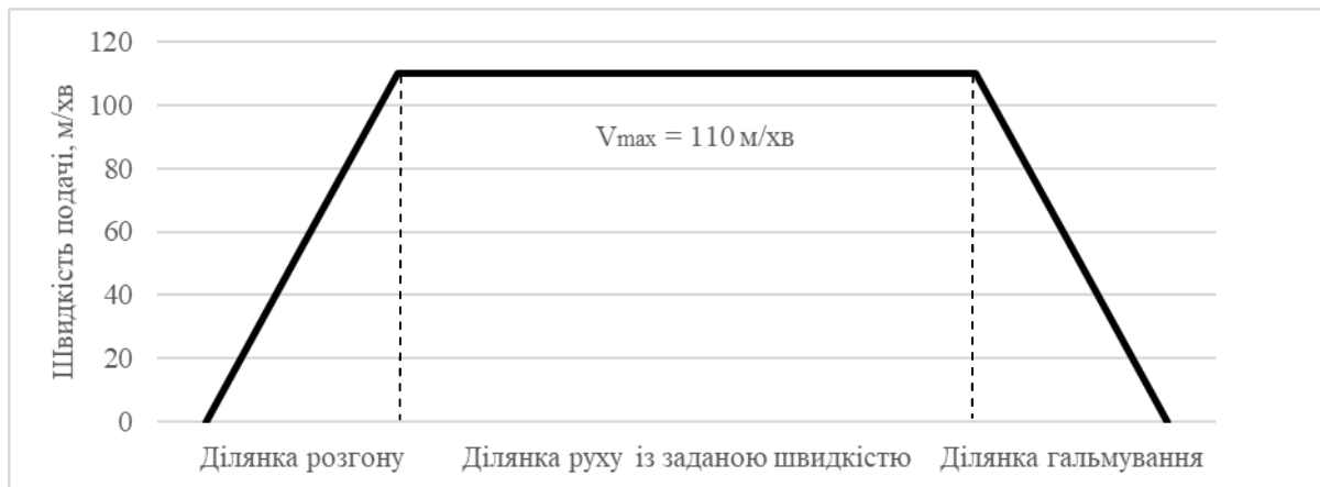
Рис. 1. Схематичне зображення складових робочого горизонтального переміщення пильного вузла в межах одного різну (зображено без збереження пропорцій)
