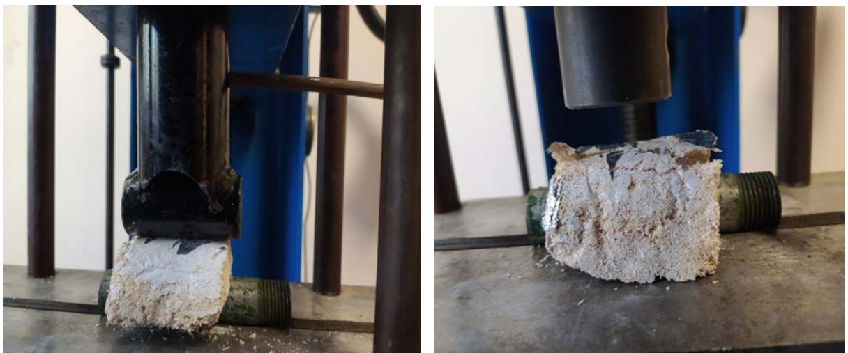
Рис. 2. Дослідження на міцність теплоізоляційних виробів з деревини
