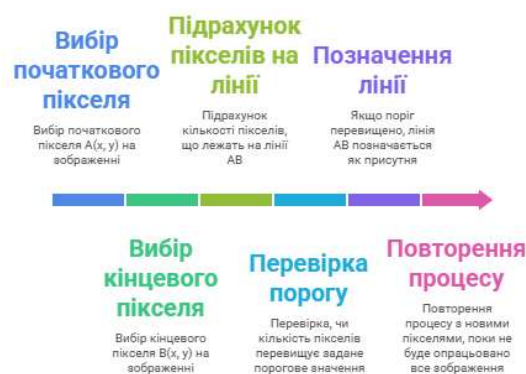
Рисунок 1. Алгоритм перетворення Хафа
